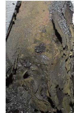
Bild: Verbranntes Frostschutzmittel im Wassermantel des Turboladers
