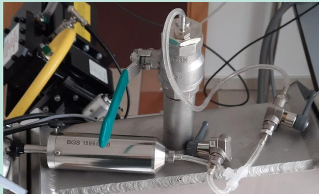
Abb. 2: Probenahme-Vorrichtung
