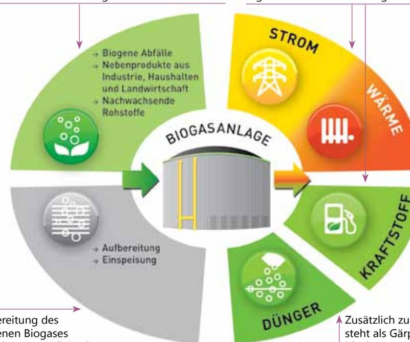
Die Aufbereitung des entstandenen Biogases zu Biomethan ermöglicht die Einspeisung in das Erdgasnetz.
