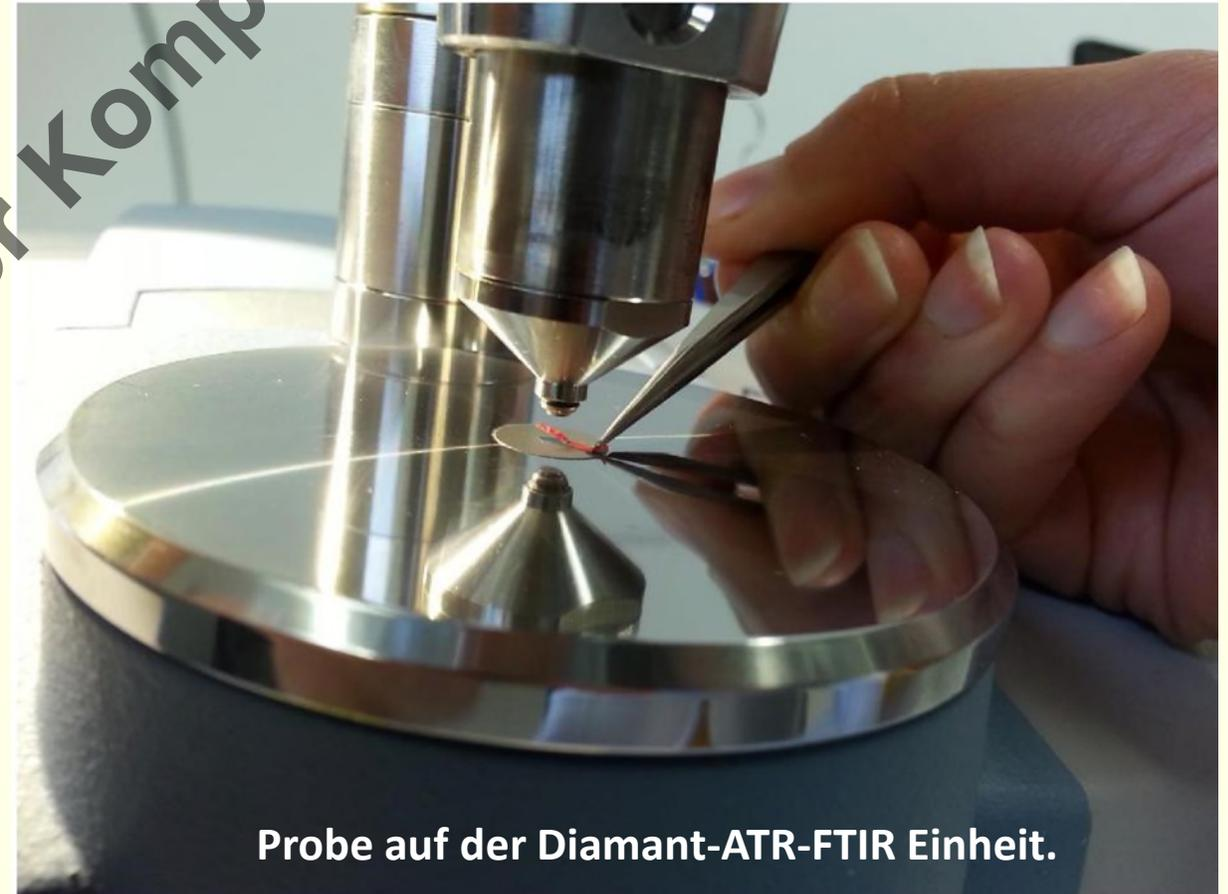
Probe auf der Diamant-ATR-FTIR Einheit.
