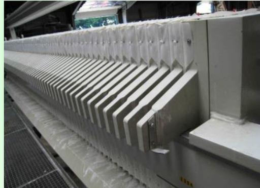
Abtrennung von Kalk mittels Kammerfilterpresse
